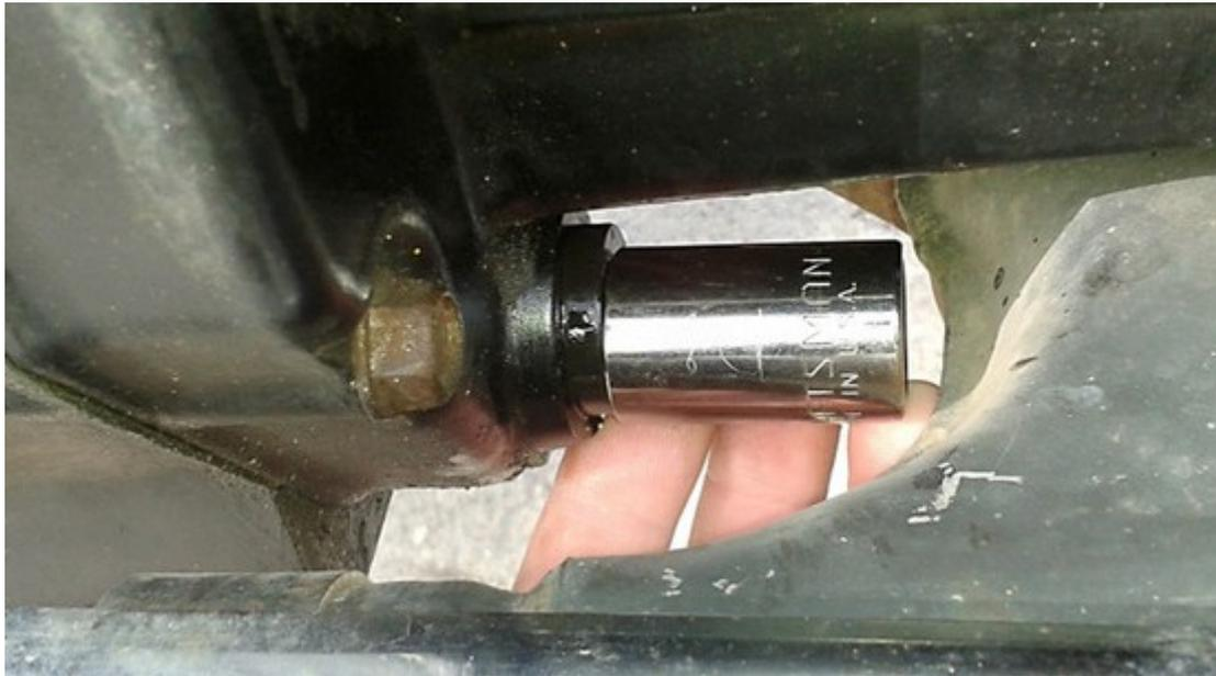
Den langen Schraubenzieher oder einen anderen geeigneten Hebel benutzen und mit Hilfe der Nuss den Simmering passend (mit dem Gehäuse abschließend) in seinen Sitz drücken. *Ich habe beim letzten Wechsel den alten Simmering mit der Dichtseite nach außen vor die Nuss gesetzt. Damit hat man bei entsprechender Nuss eine bessere Führung und gleichmäßigeren Druck auf den Ring.*
