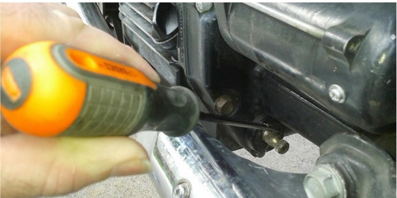
Den Schraubendreher als Hebel einsetzen und der Simmering sollte sich leicht heraus drücken lassen.
