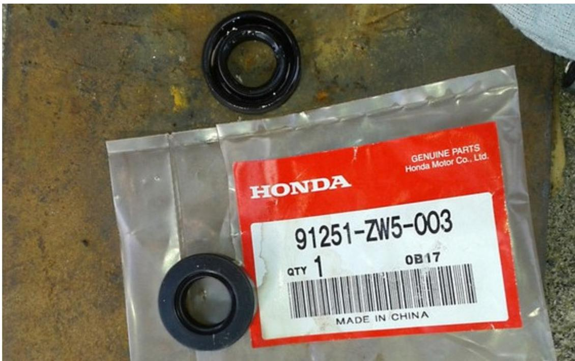
Oben der alte Simmering mit der Dichtungsseite (der offenen Seite) nach oben, unten der neue Ring mit der Dichtungsseite nach unten. Der neue Ring wird also mit der offenen Seite zum Motor hin auf die Welle geschoben.
