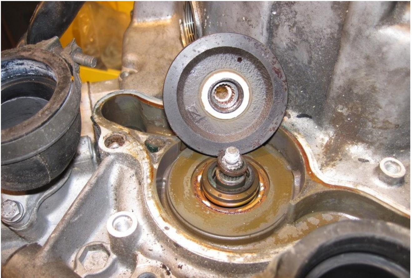
Zum Einschieben des Blechtopfs in den hinteren Motordeckel benötigt man ein spezielles Werkzeug. Welche Möglichkeiten zur Herstellung eines solchen Werkzeugs es gibt und wie es anzuwenden ist, ist im Abschnitt **WASSERPUMPEN-DICHTUNGSEINZIEHER** beschrieben.
