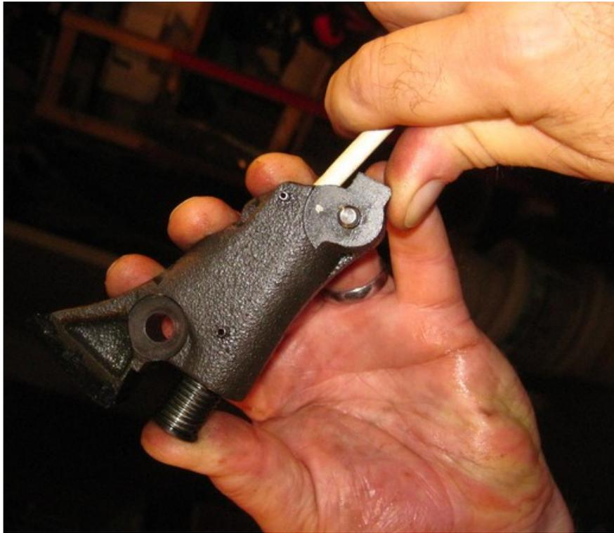
Dadurch kommt der Stempel frei und lässt sich reindrücken. So zusammengeedrückt lässt sich der Kettenspanner wieder einsetzen.
