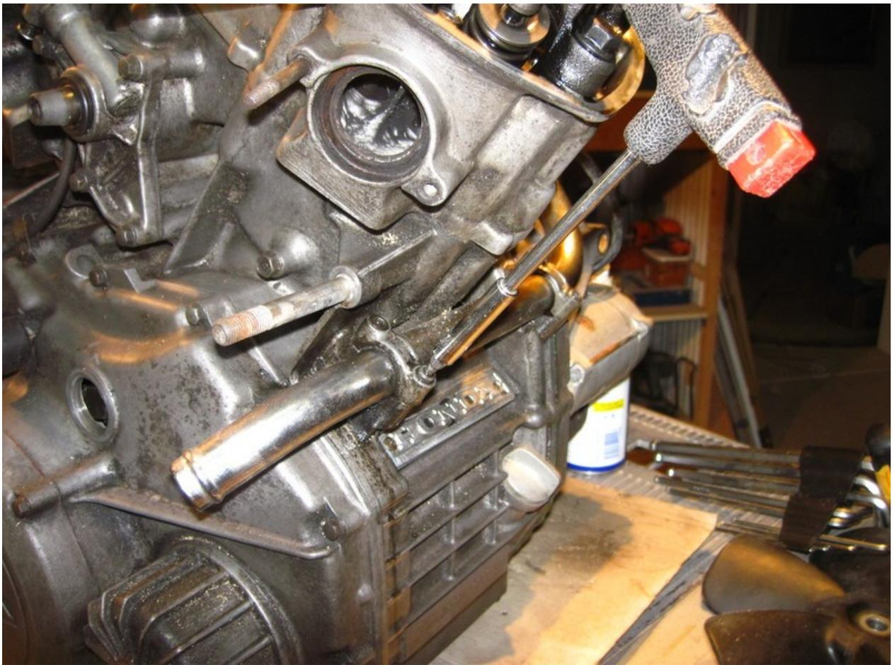
Die Schrauben waren festgebrannt. Ich mußte also diesen T-Griff mit einem Bit benutzen. Die 6-Kantschlüssel im Hintergrund wären verbogen bevor sich die Schrauben gelöst hätten.
