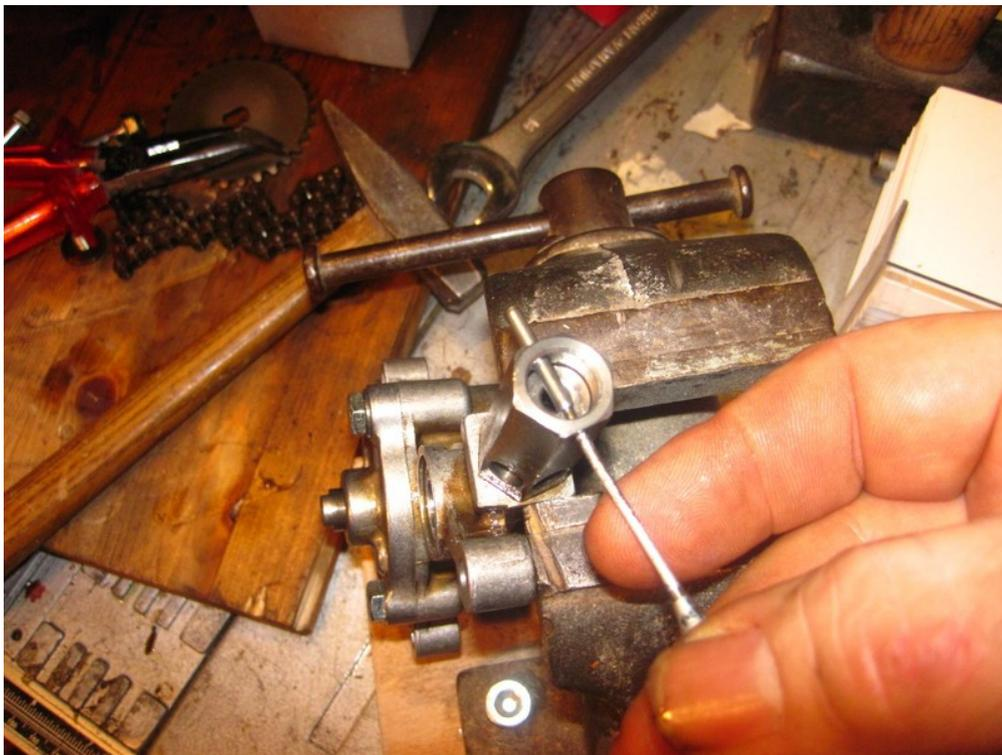
Das Öldruckentlastungsventil ist wieder zusammengesetzt. Jetzt fehlt nur noch der O-Ring für das Ansaugrohr und die Ölpumpe kann wieder eingesetzt werden.
