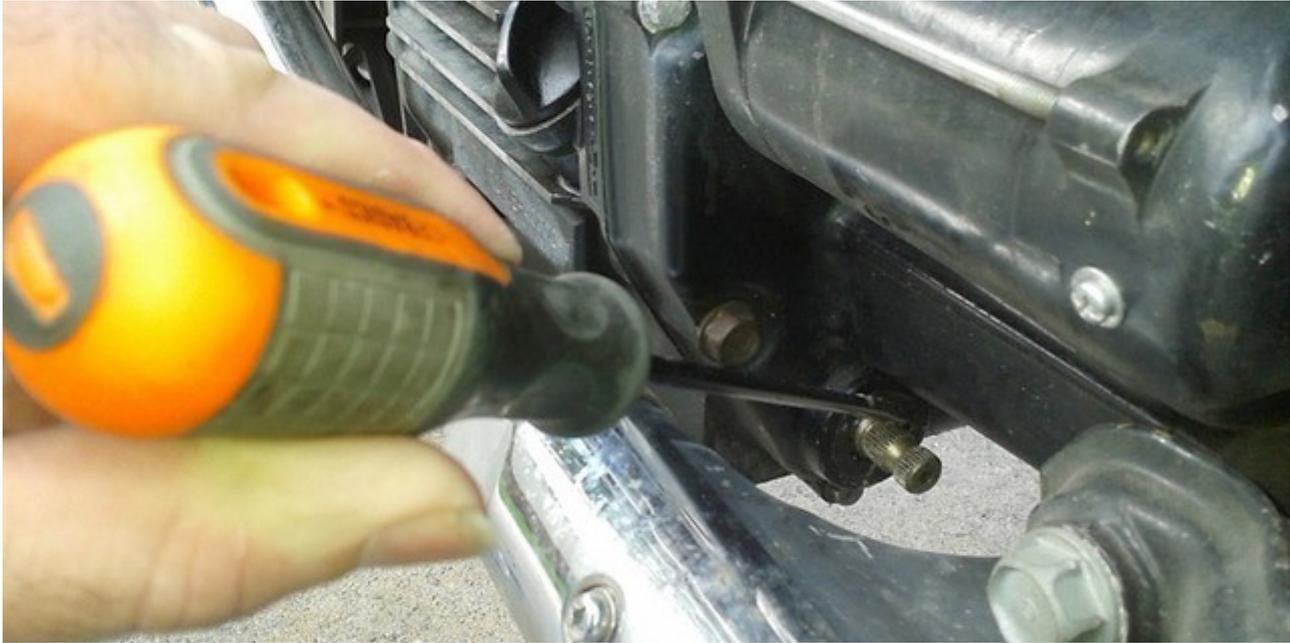
Den Schraubendreher als Hebel einsetzen und der Simmerring sollte sich leicht heraus drücken lassen.
