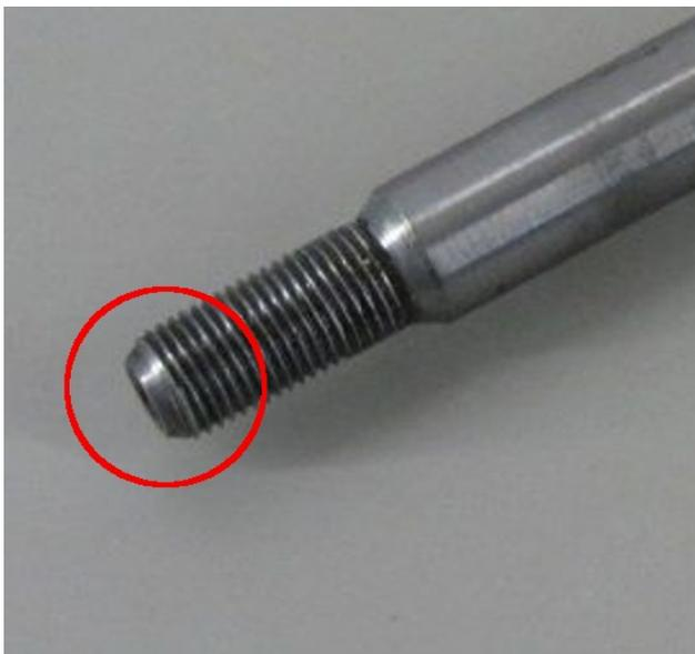
Damit drückt sich dann der Außenkonus der Vorderachse in den Gewindegang in der Nockenwelle! Gesund kann das in jedem Fall nicht sein, und dem Ansatz des Gewindes für die Befestigungsschraube des Lüfterrades wird es wohl auch nicht gut tun.
