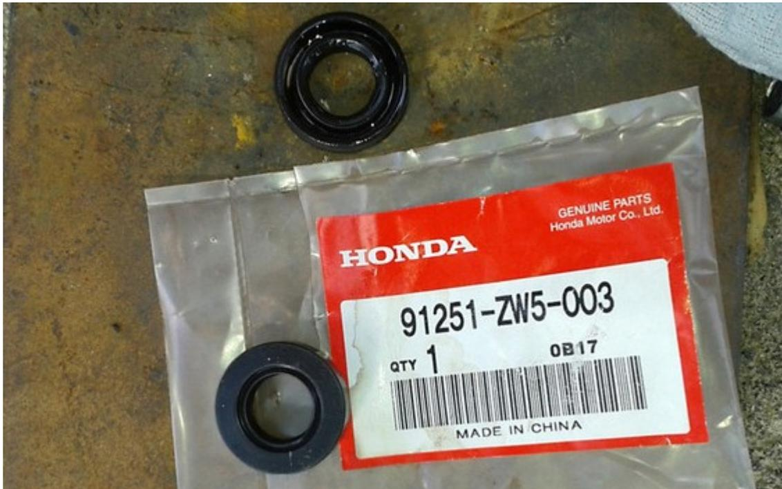
Oben der alte Simmerring mit der Dichtungsseite (der offenen Seite) nach oben, unten der neue Ring mit der Dichtungsseite nach unten. Der neue Ring wird also mit der offenen Seite zum Motor hin auf die Welle geschoben.
