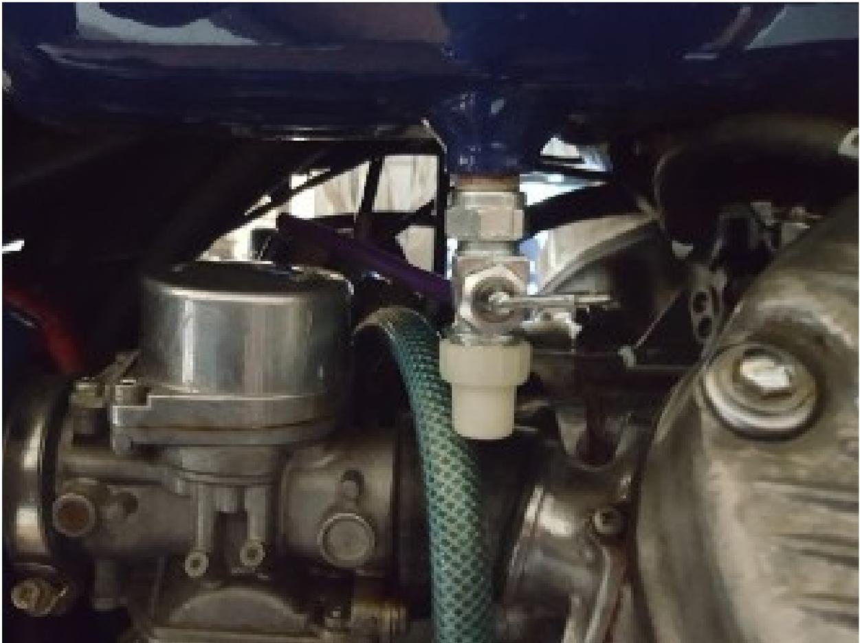
Also: für den Reinschlüssel braucht man **2(!)** Hähne mit Gewinde M16 x 1,0 und schon kann man von 21 Litern Sprit im Tank profitieren.
