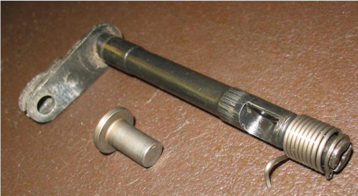
Gut zu erkennen ist auch der Seegerring, der verhindert, dass die Feder von der Welle gleiten kann. Auch die Aussparung in der Welle, in der die Ausdrückstange sitzt, ist gut zu sehen.
