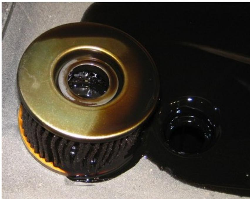
*Ich musste sie mit einem Schraubenzieher abpulen. Das ist der Grund, weshalb diese Scheiben von unerfahrenen Schraubern mit dem Ölfilter entsorgt werden.*
