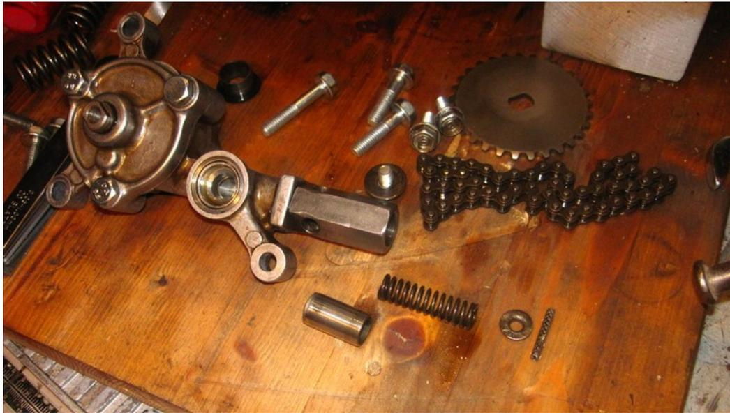
Zum Zusammenbau werden die Teile in richtiger Reihenfolge in den Zylinder gesteckt. Beim Wiedereintreiben des Federstiftes halte ich die Federsitzscheibe mit dem Austreiber gerade, sodass sie dem Federstift nicht in den Weg gerät.
