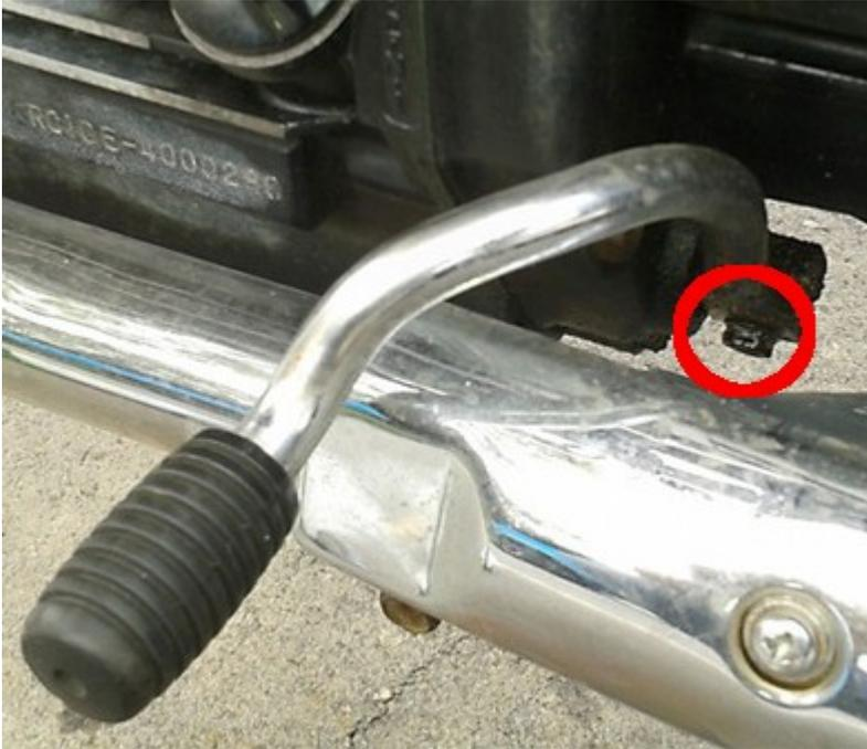
Den Schalthebel entfernen. Dazu die Schraube mit dem 10er Kopf aus der Klemmung heraus-schrauben. Dafür benötigt man die Ratsche mit der 10er Nuss.
