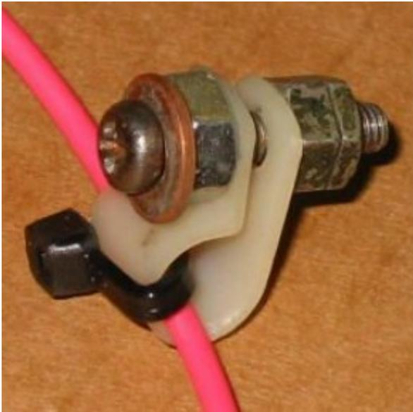
Eine Zugentlastung wurde angebracht, damit die Batteriepolzange gegen unbeabsichtigtes Lösen möglichst gesichert ist.
