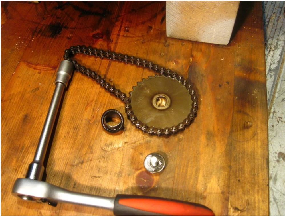
Mir gelang es tatsächlich die Gehäuseschrauben mittels eines großen Kreuzbits und der Knarre zu lösen. Das geht am besten, wenn die Ölpumpe noch eingebaut ist. Ich schätze auch das ist ein Effekt der niedrigen Laufleistung. Die Schrauben hatten noch keine Gelegenheit festzubacken.
