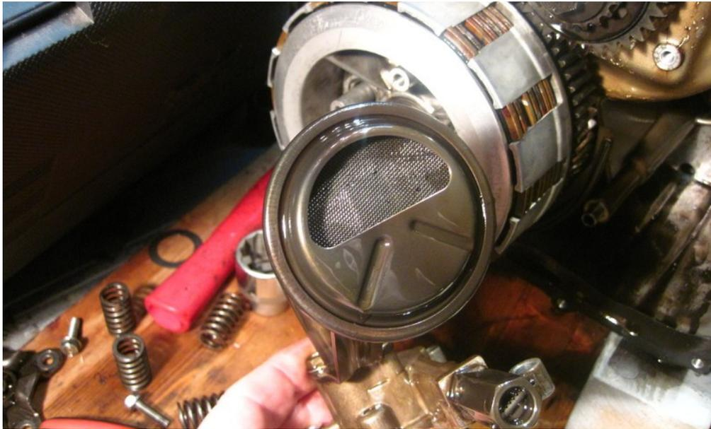
Im Ansaugflansch sitzt ein O-Ring. Dieser hier ist zwar noch relativ weich, aber platt gedrückt. Der dichtet nicht mehr! Der Flansch lässt sich ohne Widerstand abziehen und aufstecken. Der O-Ring hat die selbe Dimension wie der O-Ring vorne für die Hülse zum Ölfilter. 15 x 2,5 oder 16x2,5 bzw. 13 x 2,5 in Abhängigkeit vom Rohrdurchmesser.
