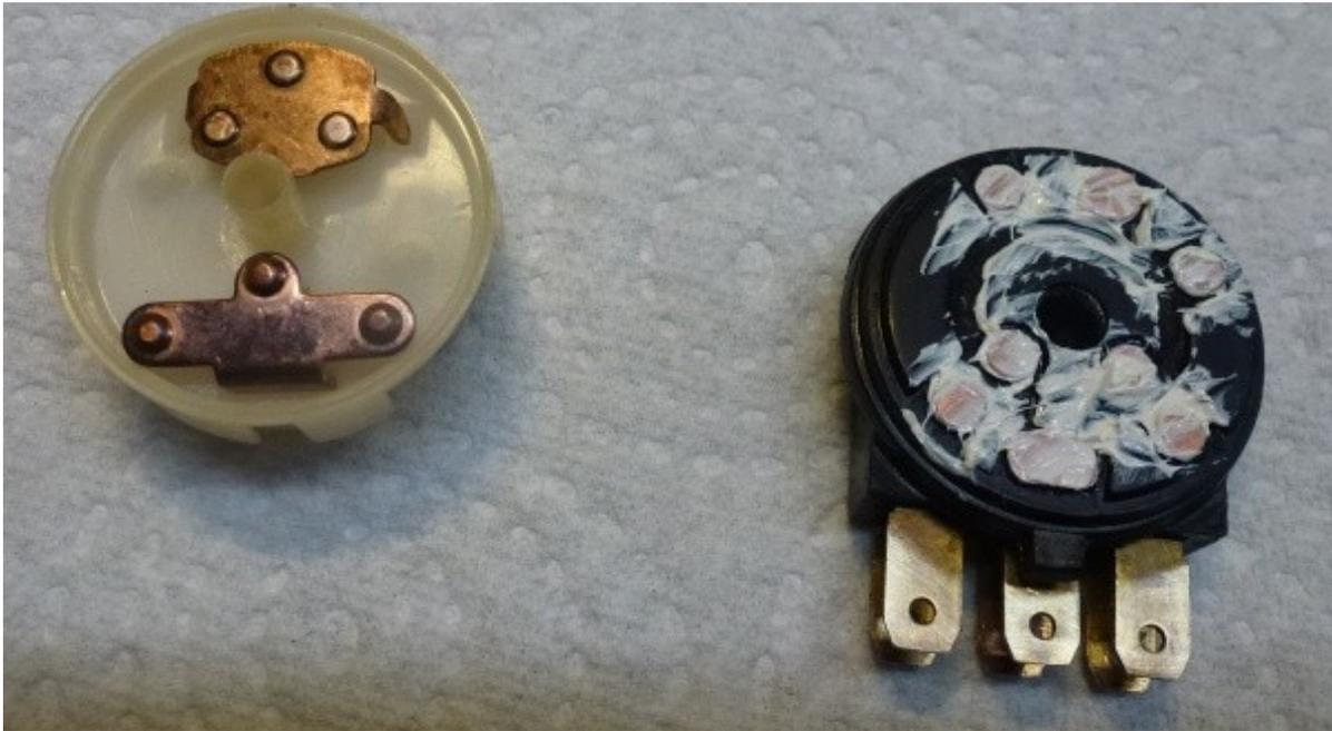
Anmerkung von mir: Man beachte die Ausrichtung der oberen kleinen Kontaktplatte im weißen Drehteller. Gegenüber dem Bild auf der vorigen Seite ist die Platte um 180° gedreht.
