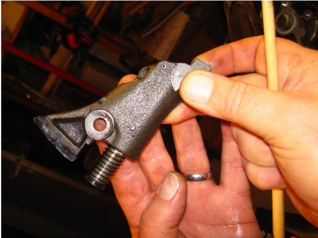
Der automatische Kettenspanner ist so konstruiert, dass er immer weiter ausfährt, aber nicht zurück geht. Um ihn nach dem Wechsel der Steuerkette einbauen zu können, muß vorne der Stempel zurück gedrückt werden. Dazu wird die Kugel hinten im Spanner...
