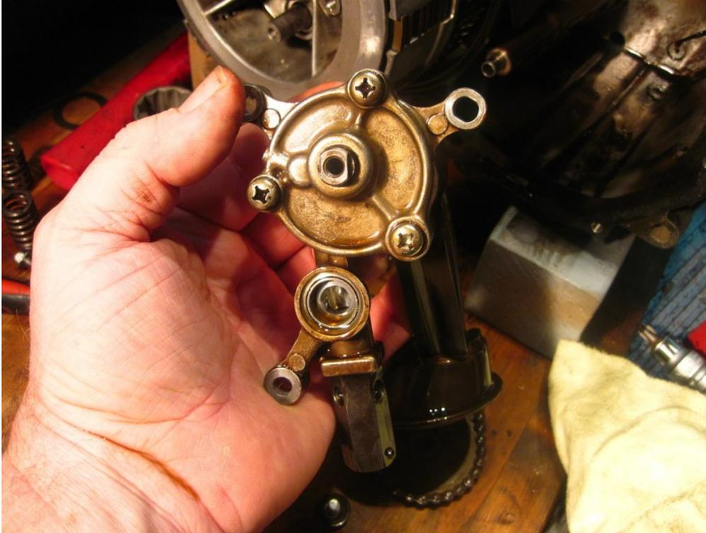
Auf der Rückseite der Ölpumpe ist das Ansaugrohr mit einem Flansch befestigt.
