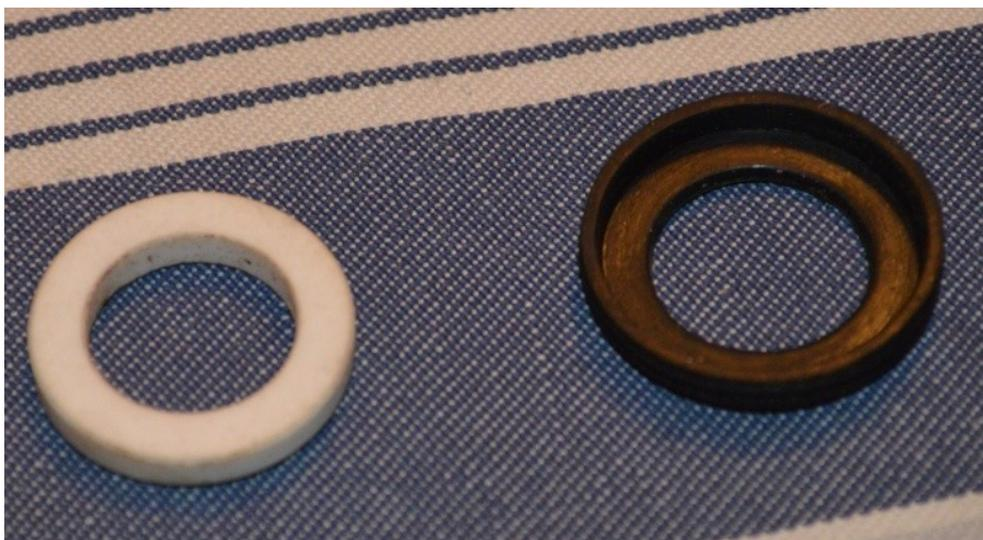
So sieht es aus, wenn die beiden Teile für den Einbau richtig zusammengesteckt wurden. Üblicherweise ist dies auch der Zustand bei Lieferung. Die Gummidichtung kommt ins Wasserpumpenrad, die Keramikdichtung zeigt in Richtung Motordeckel/Blechtopf.
