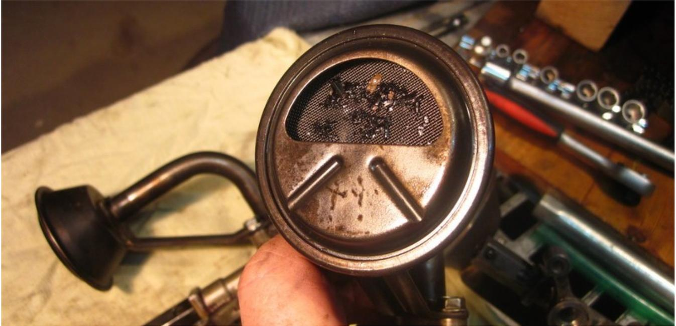
Eo schreibt dazu: Dieses Sieb hat feine Tropfen von Dichtmasse angesaugt. Sie verkleistert das Sieb und ist kaum zu entfernen, da sie immer noch klebrig ist.
