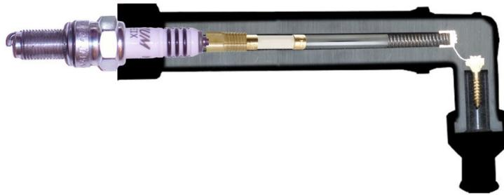
Die Länge von Alustab und Widerstand beträgt rd. 55,1 mm (umgerechnet aus der Angabe 2.170 inch) und die Dicke rd. 4,8 mm (umgerechnet aus der Angabe 0.190 inch).
