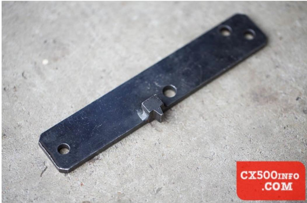
Der einzelne Zahn greift in das hintere fest mit der Kurbelwelle verbundene Zahnrad. Das ist auf dem nachfolgenden Bild zu erkennen:
