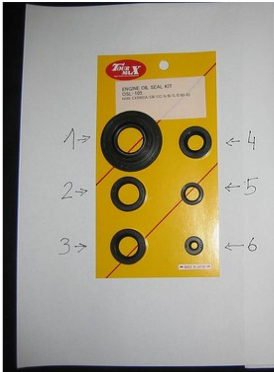
1. Hinterer Motordeckel, Getriebeausgang/Kardananschluß
