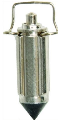
Der Vorteil (?) der Schwimmerkonstruktion ist, dass man die Höhe des Schwimmerstandes durch Biegen der Metallbrücke bzw. der Zunge, an der die Schwimbernadel hängt, einstellen kann.
