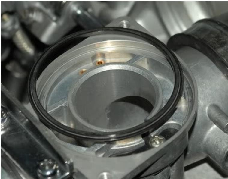
Wenn der Dom und der Unterdruckkolben des rechten Vergasers entfernt wurden, ist unbedingt darauf zu achten, dass der Ring wieder richtig herum, nämlich mit der Lippe nach oben, wieder eingebaut wird.
