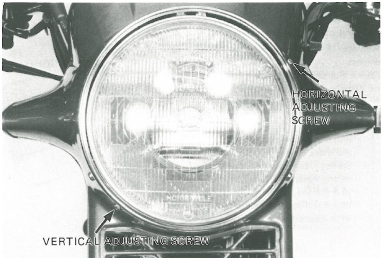
**VERTICAL ADJUSTING SCREW** = Schraube zur Ausrichtung der Höhe
