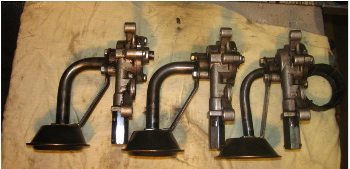
Von links nach rechts: Ölpumpe mit dickem Ansaugrohr, kurzer Abstand zwischen dem Ansaugsieb und dem Entlastungsventil.
