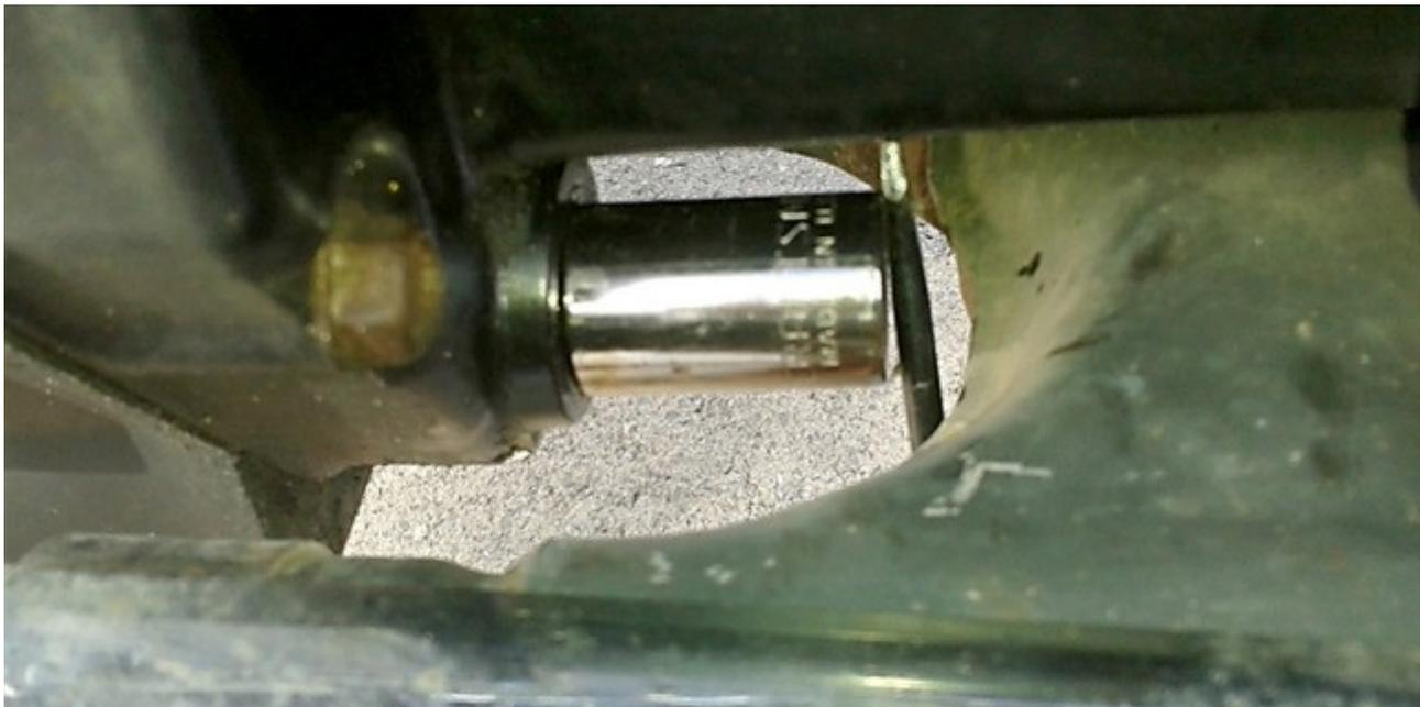
Jetzt muss der Schalthebel wieder aufgesetzt werden. Damit der in der richtigen Stellung montiert wird, hat er einen Markierungspunkt eingeschlagen.
