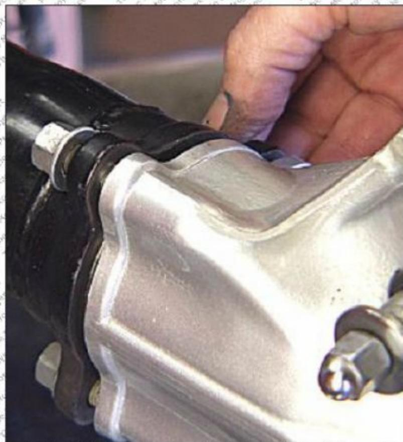
Die Muttern der Befestigung der Endantriebs-einheit lösen, bis 3 bis 4 Gewindegänge zu sehen sind.
