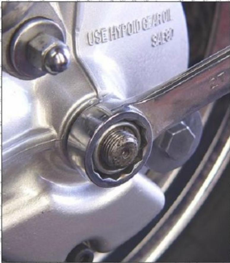
Die Achsmutter aufschrauben und mit dem nach Handbuch vorgeschriebenen Wert (5,5 – 6,5 kgm bzw. 55 – 65 Nm) festziehen und den Sicherungsplint anbringen, wenn erforderlich. (Diese V 65 Magna hat statt eines Sicherungsplints eine selbstsichernde Mutter.)
