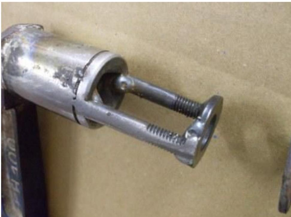
*Prinzipiell funktioniert es so wie das von Guelli02 vorgestellte, nur mit dem Unterschied, dass das Druckstück mit der Schraubzwinde fest verbunden ist und nicht weg rutschen kann und man um das Ventilschaftende wesentlich mehr Platz zur Verfügung hat.*
