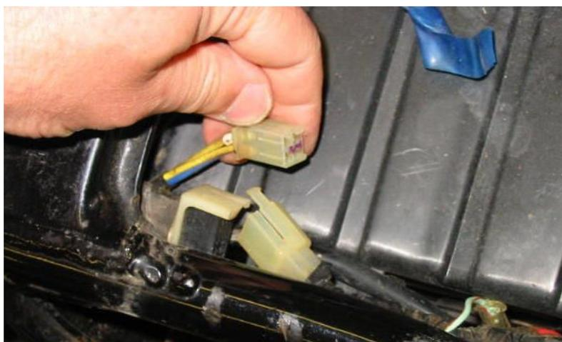
Trennen Sie zunächst den Stecker für die Pickup-Spule.
